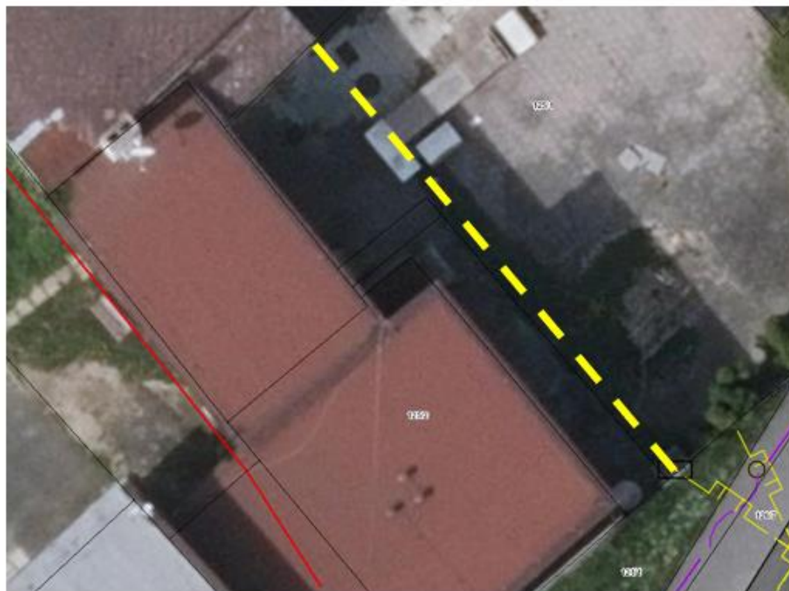
Příloha č. 2 - vyznačení vedení plynovodní přípojky
